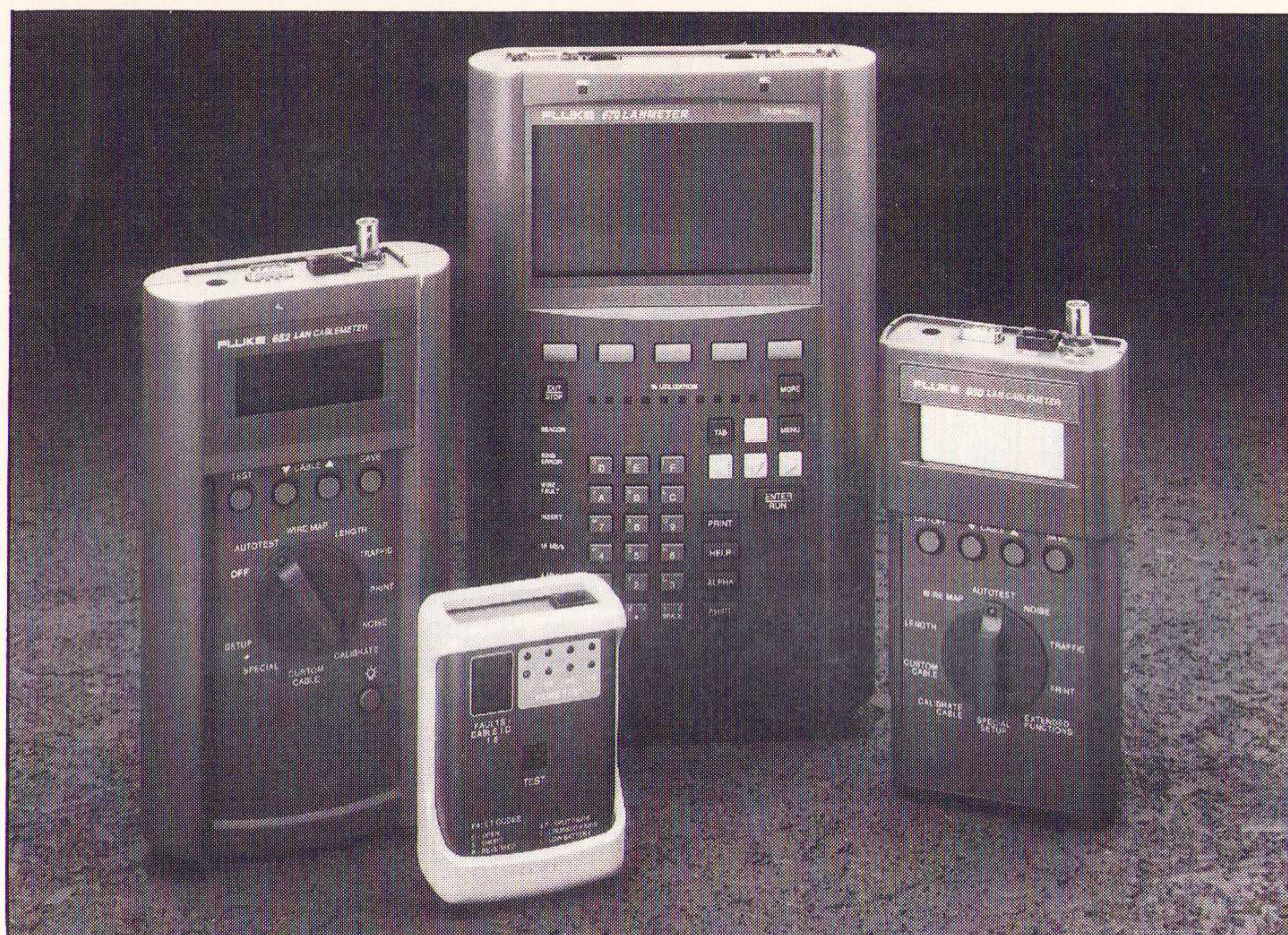
Fig. 1 Rechts de LAN-kabeltester Fluke 650, links de LANMeter Fluke 670, die de eigenschappen van de kabeltester en die van een protocoltester combineert.
